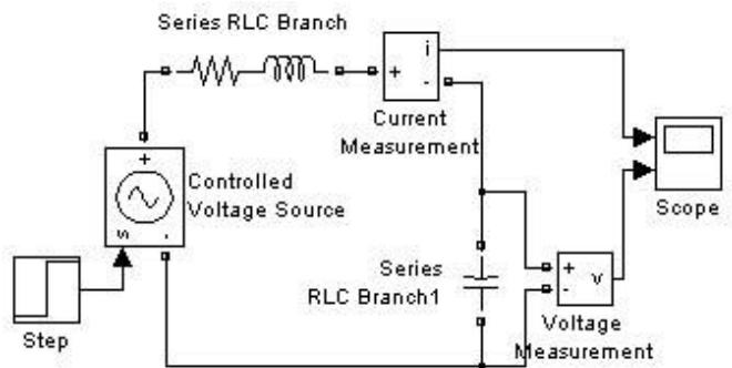
5. Соберите схему с использованием последовательного колебательного контура. На схеме источник переменного напряжения амплитудой 100 В и частотой 50 Гц подключается к цепи с параметрами: R = 0.1 Ом, L = 0.001 Гн и C = 0.001 Ф.
